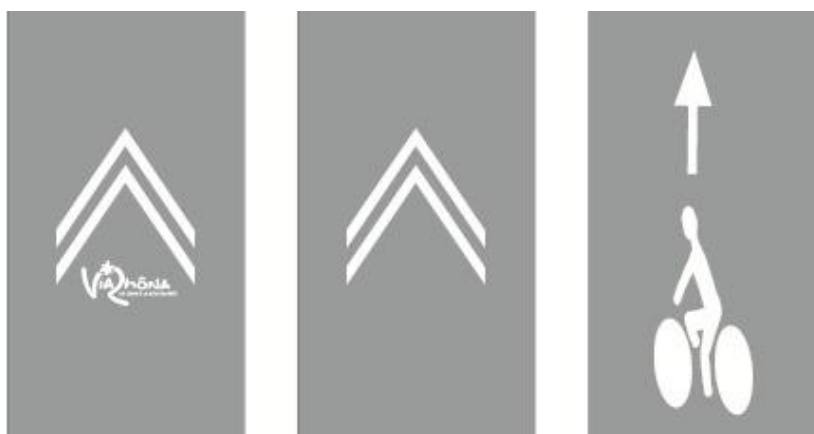
Exemples de représentations au sol assurant la continuité cyclable
