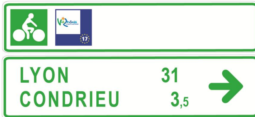
Panneau de type Dv12 (lame supérieure) et Dv43a (mentions)
